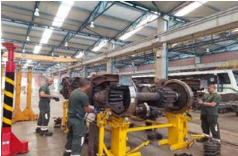
Diseñamos y construimos un banco de desarmado y armado de bogies para **mejorar las condiciones ergonómicas** al momento de realizar actividades en estos equipos.
